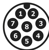
电缆侧: M12, 8针, A-coded, 母头 (孔头)
